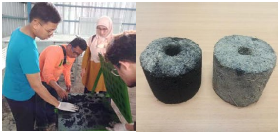
Fig. 2. Local MSME's sago dregs briquette production
