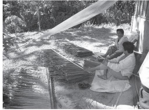
図.12 サゴヤシ葉を用いた屋根葺き材。
